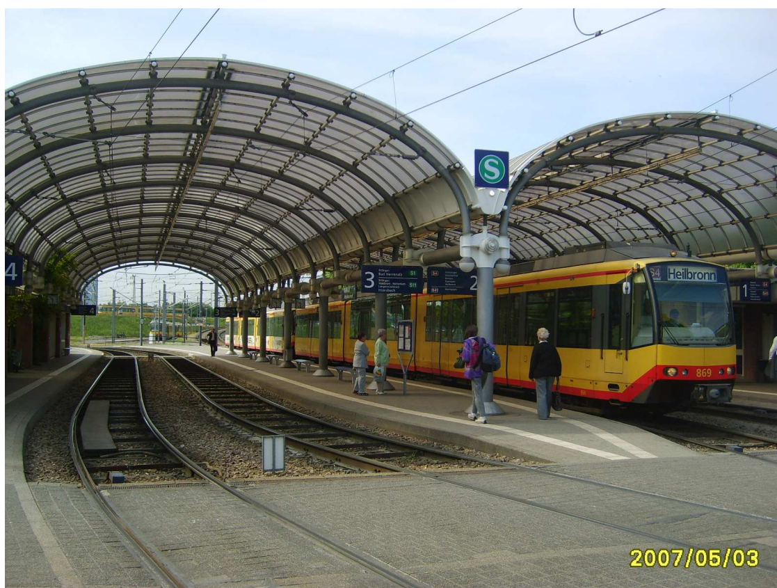
Fot. 7.4. Przykład tramwaju dwusystemowego w miejscu połączenia z linią kolejową (Karlsruhe, Niemcy).
