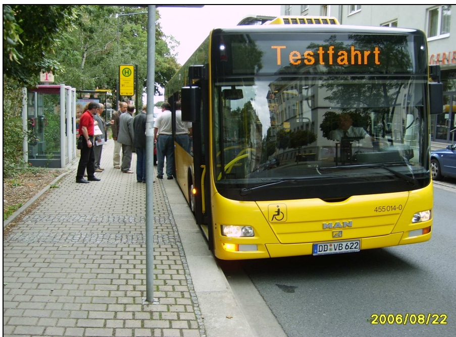
Fot. 5.27. Autobus ustawiony w tej samej odległości od peronu przystankowego na całej długości pojazdu – Drezno (Niemcy).
