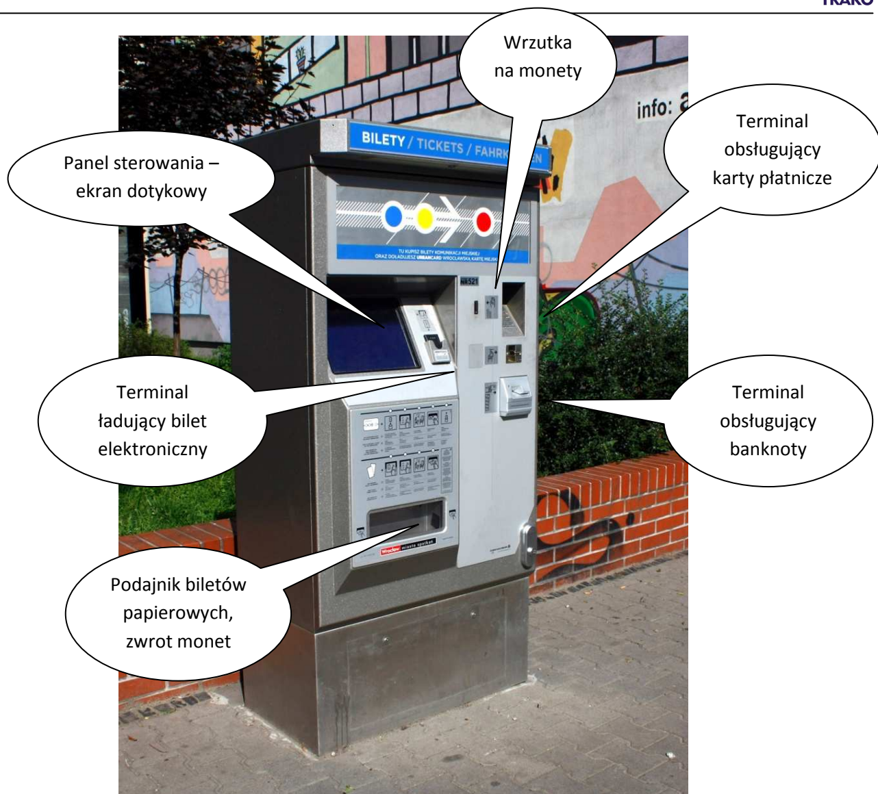
Fot. 5.30. Przykład automatu sprzedającego i doładowującego bilety elektroniczne oraz tradycyjne (Wrocław – Polska).
