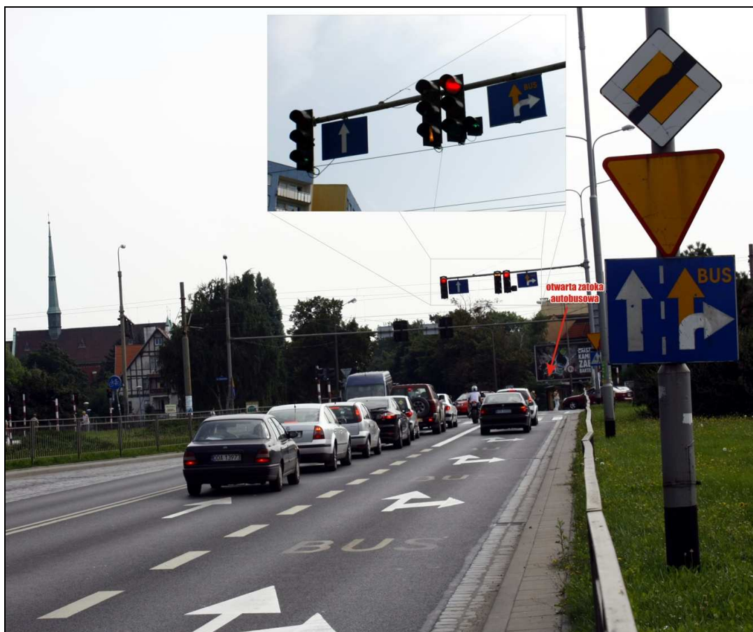
Fot. 5.32. Priorytet dla komunikacji publicznej – wykorzystanie prawoskrętu na przejazd autobusów na wprost w zatokę autobusową.
