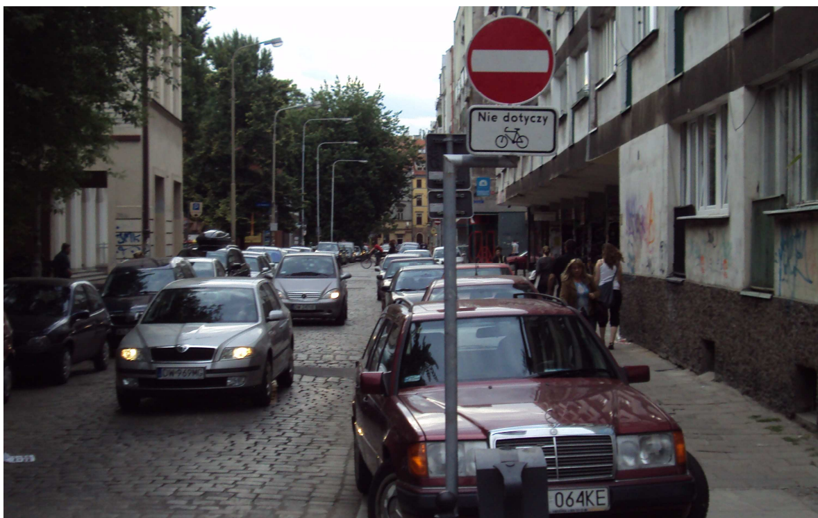
Fot. 4.5. Przykład dopuszczenia dwukierunkowego ruchu rowerowego na ulicy jednokierunkowej przy użyciu znaku T-22, bez oznakowania poziomego jezdni (Wrocław, Polska).
