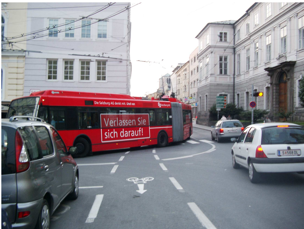
Fot. 4.4. Kontrapas rowerowy na ulicy jednokierunkowej (Salzburg, Austria).
