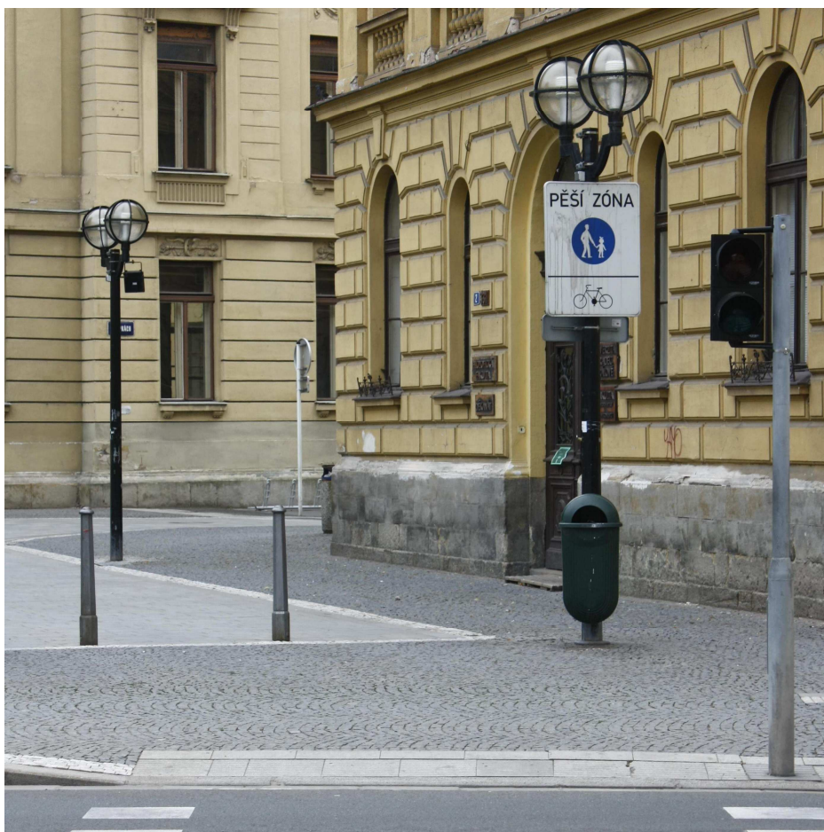
Fot. 4.7. Deptak, na którym dopuszczony jest ruch rowerowy. Wjazd i parkowanie samochodów przed deptakiem uniemożliwiają dwa słupki (Hradec Kralove, Czechy).
