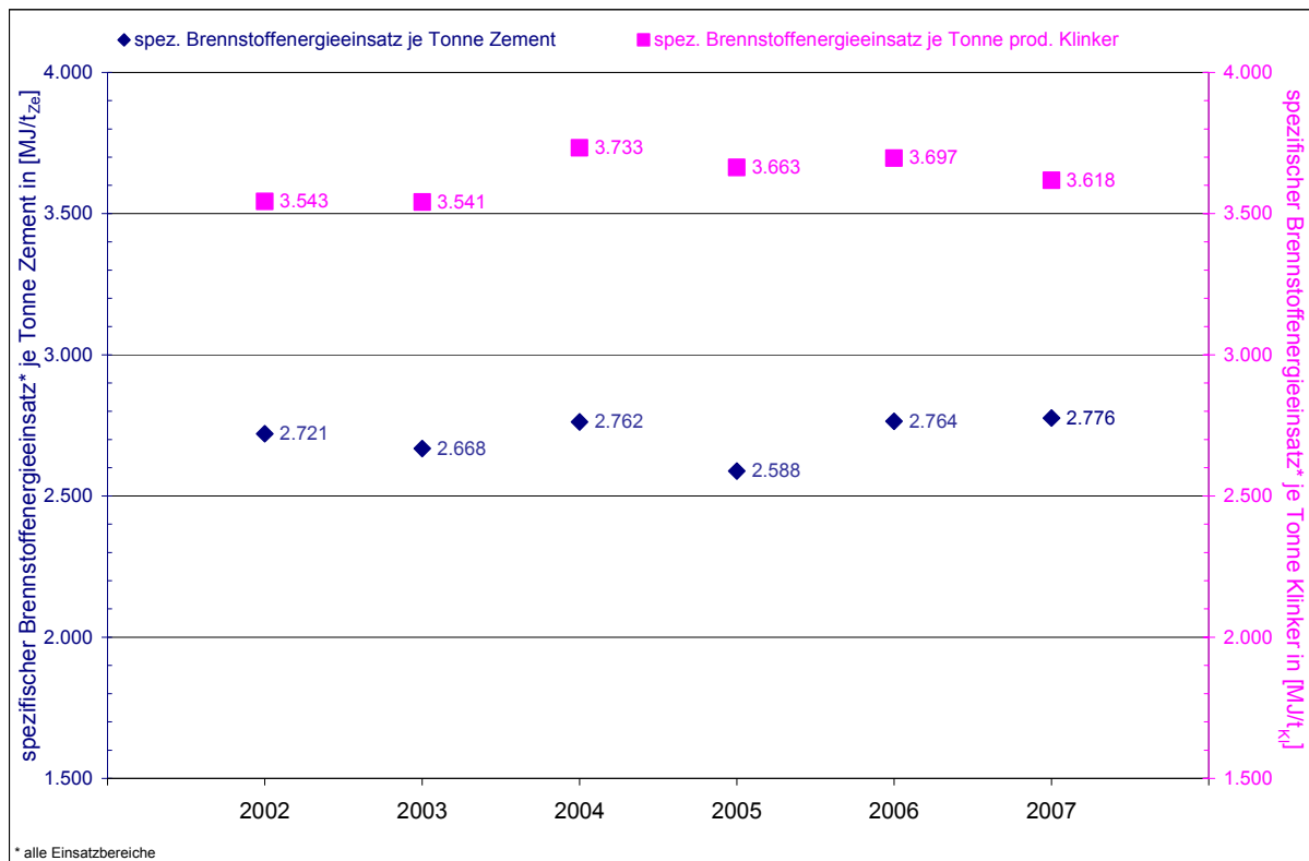
Abbildung 3-8: auf die Tonne Zement bzw. auf die Tonne Klinker bezogener spezifischer Brennstoffenergieeinsatz in Anlagen der österreichischen Zementindustrie für den Beobachtungszeitraum 2002 bis 2007
